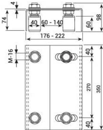
El soporte regulable está diseñado para ejercer el guiado lateral, desde la parte superior, de las puertas correderas de carga pesada. Las medidas de la pieza son:
