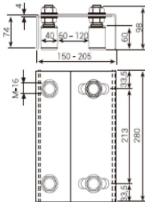
El soporte regulable está diseñado para ejercer el guiado lateral, desde la parte superior, de las puertas correderas de carga media. Las medidas de la pieza son:
