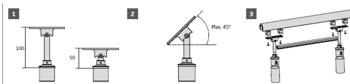
El adaptador SA-418 debe ir junto al soporte ref. BG-01 para sujetar el pasamanos ref. RP-1400. Para la instalación es necesaria la cola especial para inox o bien Nural 21 o soldadura en frío similar. Y una llave Allen, ninguno de los dos artículos está incluido.
