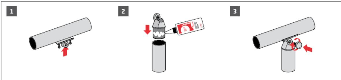
Se une al poste de la barandilla mediante el pegamento especial para inox. Y al pasamano mediante tornillos rosca chapa de 4,8 mm, por ejemplo, y también encolado. Ni el pegamento ni la tornillería van incluidos.
