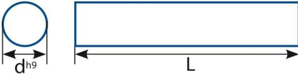
Cuchilla redonda diseñada para el cilindrado interior o mandrinado de piezas, fabricado en acero HSSE con una aleación del 10% de Cobalto. De forma lisa para que cada unos pueda darle la forma deseada.
