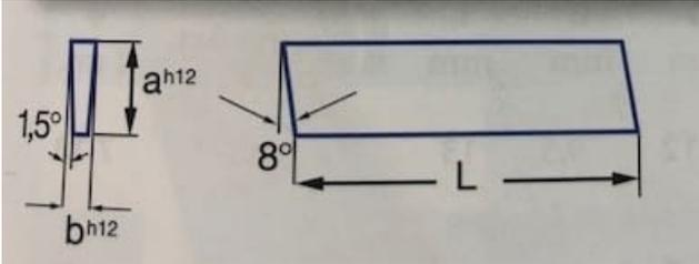
Cuchilla trapezoidal de composición HSSE con un 10% de Cobalto. Es una cuchilla lisa para que cada uno la corte con la amoladora según su necesidad. La forma trapezoidal está pensada para el ranurado.
