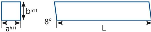
Cuchilla cuadrada de composición HSSE con un 10% de Cobalto. Viene lisa para que cada uno pueda darle la forma que desea con la amoladora. La forma cuadrada está pensada para el mecanizado exterior de la pieza.
