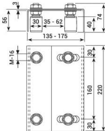
El soporte regulable está diseñado para ejercer el guiado lateral, desde la parte superior, de las puertas correderas de carga media (250 Kg máximo y/o 12,95 m<sup>2</sup> de área total). Las medidas de la pieza son:
