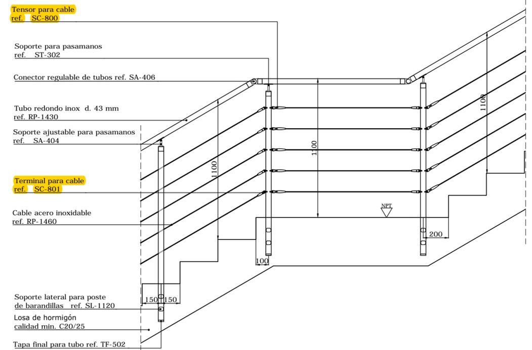
**Detalle unión tramos inclinados con horizontal**
